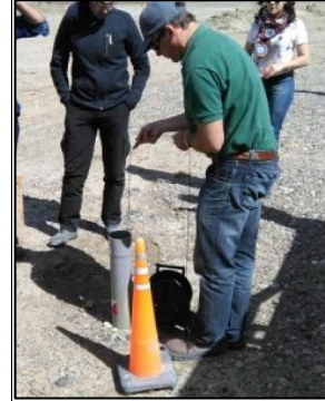
Fotografía 9.3. Medición de profundidad del nivel de agua en pozos geotécnicos existentes.
