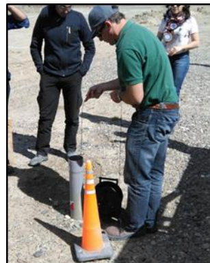
Fotografía 15. Medición de nivel de agua en pozos geotécnicos existentes
