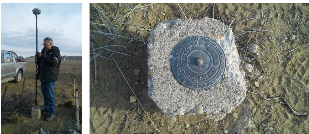
Figura 3.2: Determinación de la cota del punto auxiliar PF1(373).
