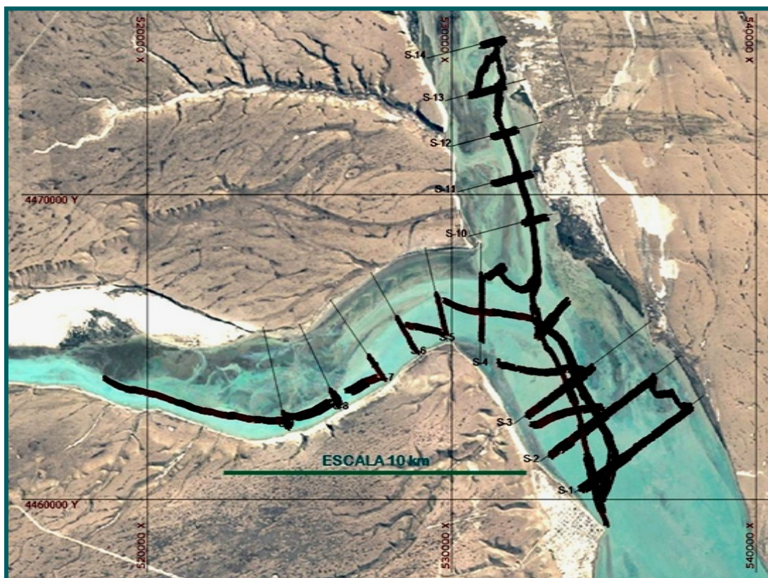
Figura 20 - Ubicación, sobre la imagen del estuario de las líneas batimétricas levantadas, aproximadamente 69.5 km
