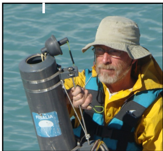
Figura 25 - Botella Niskin para muestras de agua, abierta, lista a ser sumergida. El cierre se produce accionando una segunda línea con una clavija, que libera las tapas, las que se cierran herméticamente.
