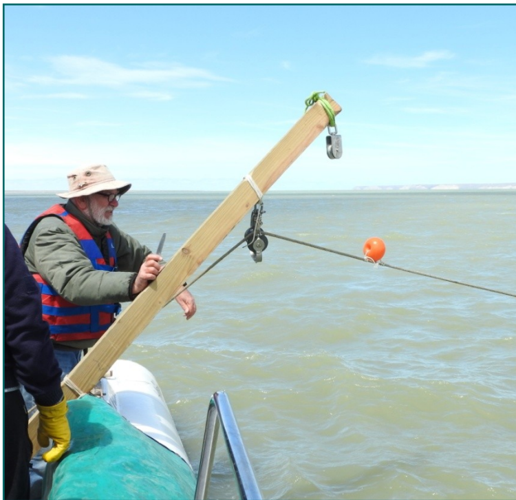
Foto 2 - Levantando la línea de recuperación con el malacate de motor. Se observa una boyita de flotabilidad, que mantiene la línea separada del fondo.
