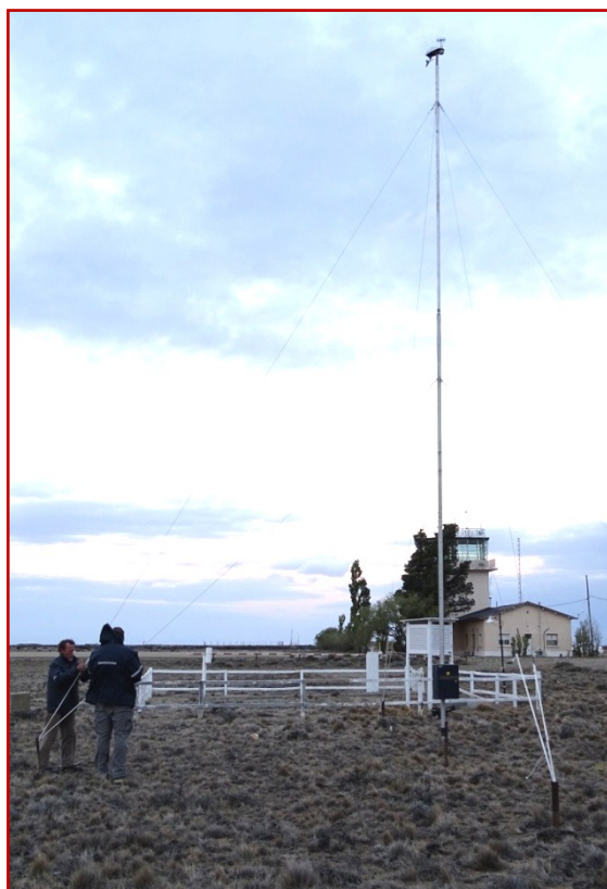
Figura 17 - Abajo: La estación funcionando, en su torre. Derecha: La unidad de sensores, en el tope de la torre, y la unidad de registro
