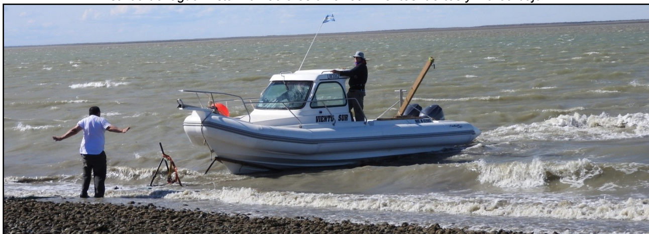
Figura 31 - La lancha Viento Sur colocándose sobre su tráiler, posicionado en la costa y sumergido para la maniobra de salida del agua. Esta maniobra es difícil con vientos fuertes y marea baja.
