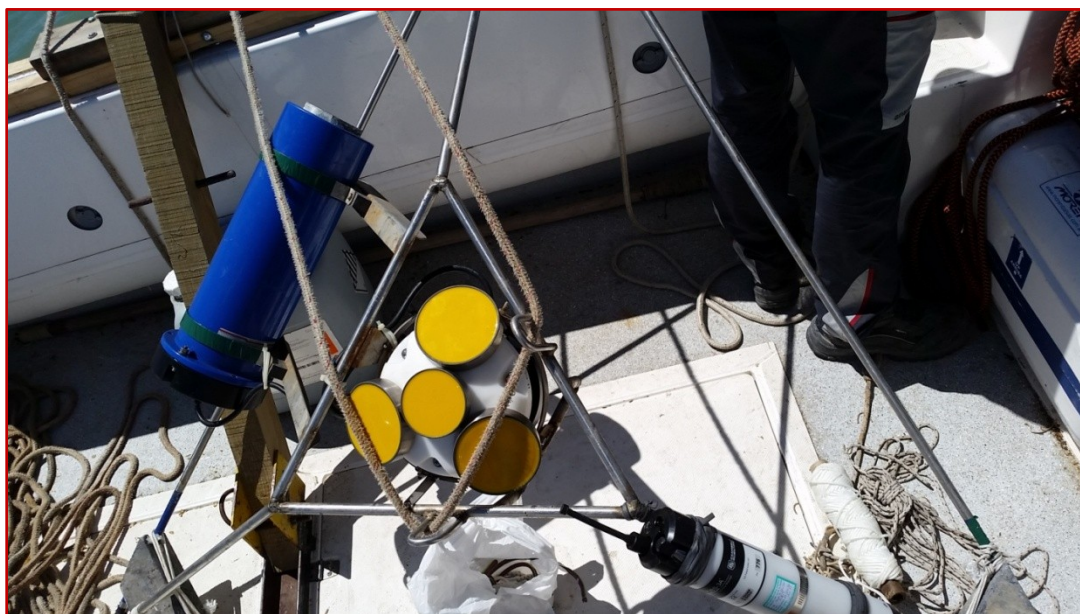
Figura 03 - El implante completo con el equipo ADCP AWAC de 400 kHz (transductores amarillos), su contenedor de baterías (cilindro azul), y el equipo CTDTu OBS 3A, listo a ser fondeado en el Punto Mar.
