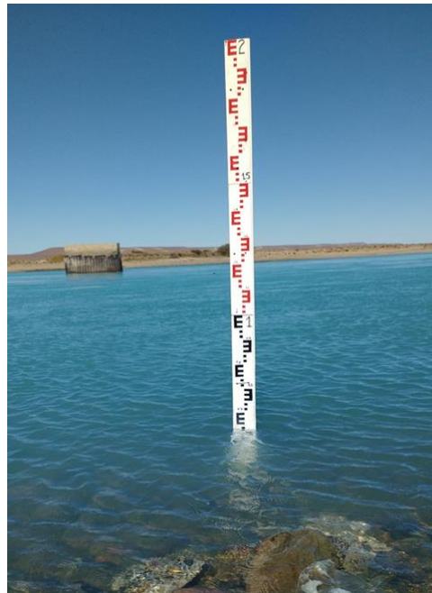
Figura 4.10: Escala colocada en el Puente Viejo.
