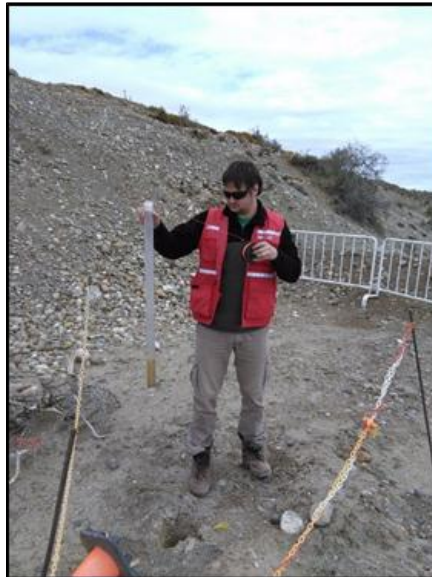
Fotografía 9.8. Toma de muestras de pozos mediante bailer, para medición de parámetros in situ.
