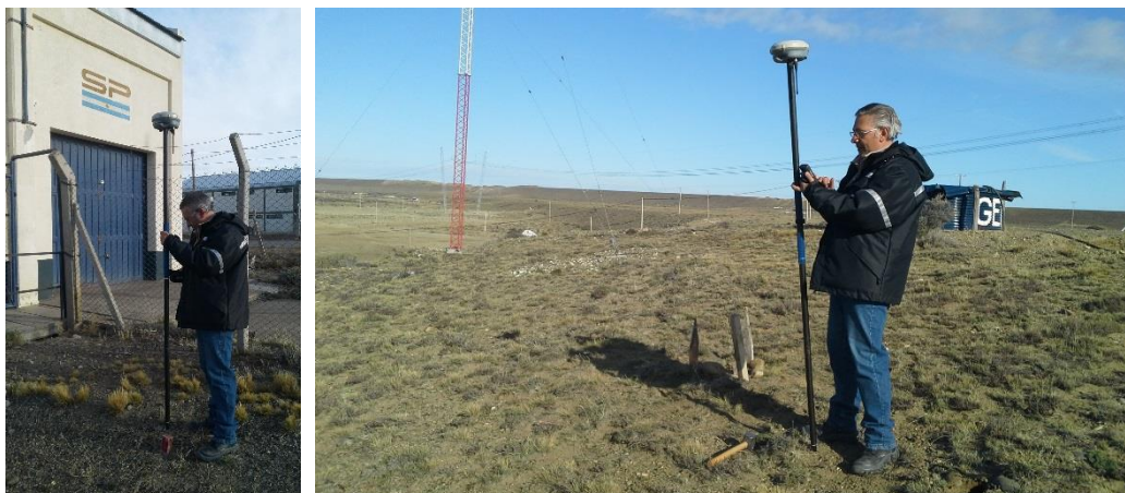
Figura 3.3: Determinación de cotas ING en (a) Planta Potabilizadora y (b) destacamento del GEOR.
