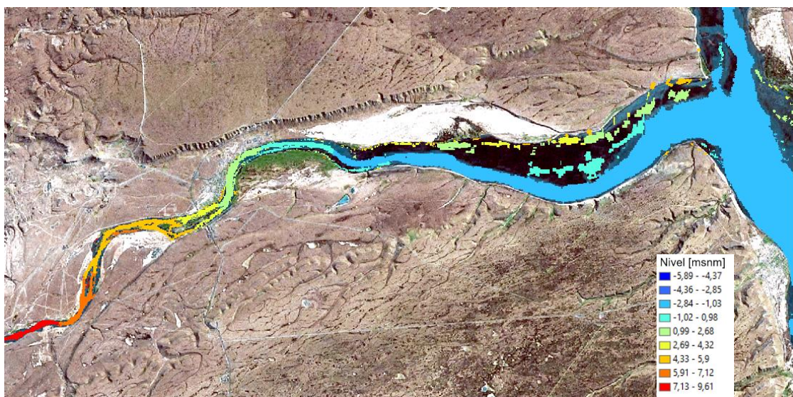
Figura 4.8: Nivel de la superficie libre en bajamar para escenario de Q_{SC}=200m^3/s y \Delta H=4,00 m.
